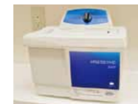
超音波洗浄機 超音波と洗浄液で洗浄します
