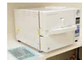
滅菌器 真空と高温の蒸気で滅菌します
